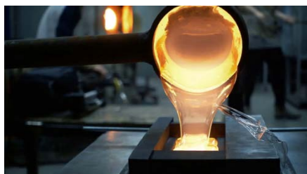
Рис. 3. Розплавлене скло заливають у форму
