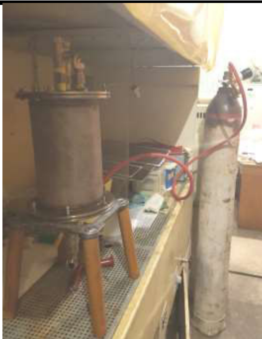
Рис. 1 - установка для дослідження каталітичної гідратації ацетилену із застосуванням гомогенного металокомплексного каталізатору.
