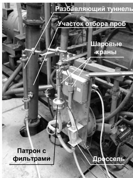
Рис. 2. Результаты монтажа и испытаний МКТ-2 на тормозном стенде дизеля 4СН12/14: а – общий вид МКТ-2; б – результаты исследований выбросов ТЧ с ОГ дизеля: 1 – n = 1000 \text{ мин}^{-1} ; 2 – n = 1500 \text{ мин}^{-1} ; 3 – n = 2000 \text{ мин}^{-1}
