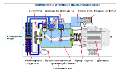
Рис. 10. Безмасляный компрессорный агрегат типа «W-180Т»
