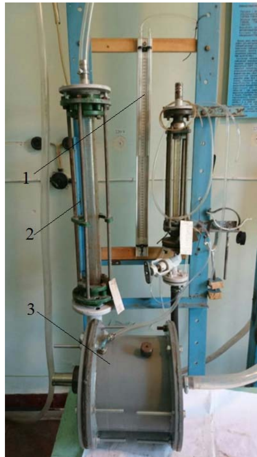
Рис. 2. Основные устройства экспериментальной установки: 1 – дифференциальный манометр; 2 – ротаметр; 3 – экспериментальный блок
