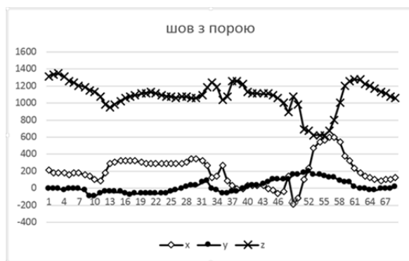
Рис. 7. Магнітне поле для зразків із зварним швом та поодиноким порою
