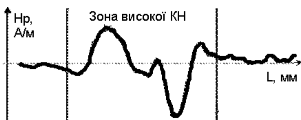
Рис. 4. Зона з концентрацією механічних напруг, яка виявлена на діаграмі нормальної складової магнітних напружень
