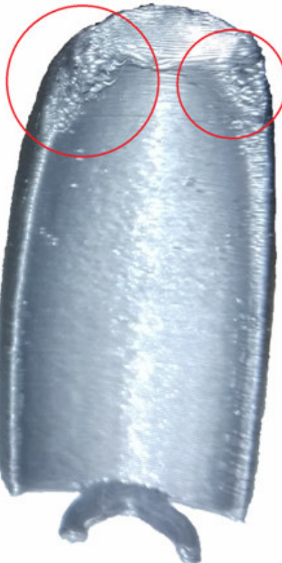
Рис. 2. Загальний вигляд надрукованої деталі з оплавленими гранями
