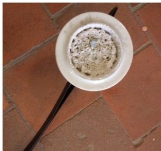
Рис. 1. Загальний вигляд розплаву скла з теплоносієм (суміш солей)
