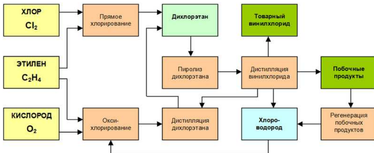
Рис. 1. Блок-схема производна винилхлорида по сбалансированному методу
