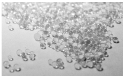
Рис. 2. Диспергирующий материал (стеклянные шарики d = 1 - 1,2\text{мм} )
