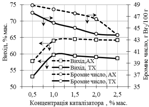
Рис. 1. Залежність виходу та бромного числа ТНПС від концентрації каталізатора (ТХ і АХ) у реакційній суміші ( \tau = 3,5 год., T = 373 К)
