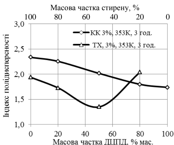
Рис. 6. Залежність індексу полідисперсності продуктів, отриманих в присутності КК і ТХ, від складу реакційної суміші ( T = 353 \text{ K} , \tau = 3,0 \text{ год.} , C_{\text{кат.}} = 3 \text{ \%мас.} )
