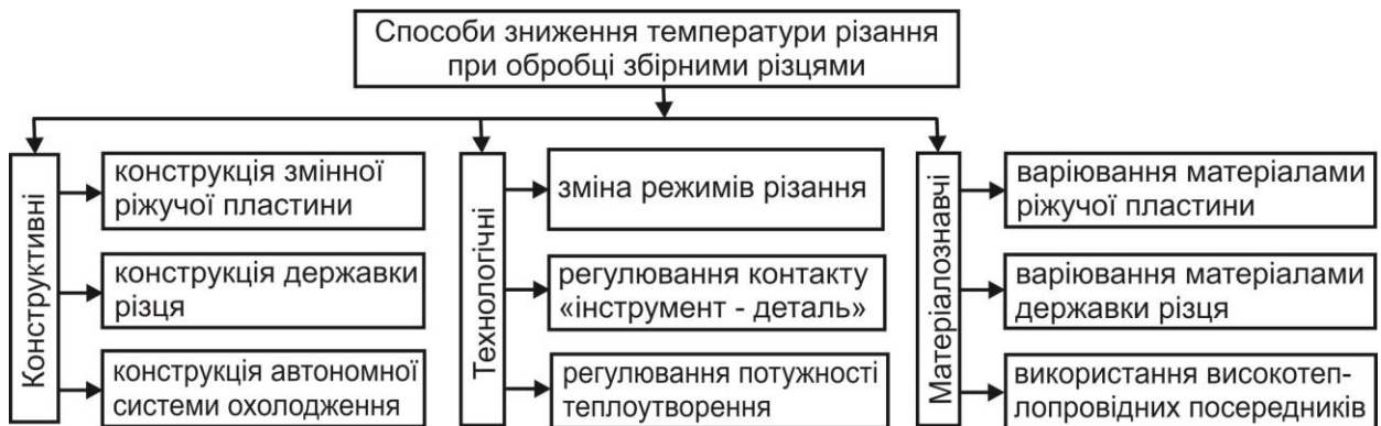
Рис. 2. Класифікація способів зниження температури різання при обробці збірними різцями
