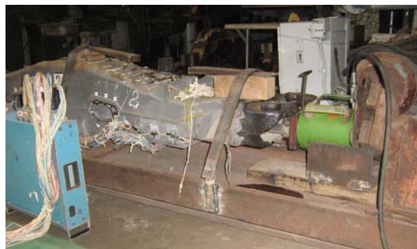
Рис. 7. Навантаження балки надресорної навантаженням яка додається до торця балки ( H )
