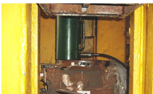
Рис. 4. Навантаження надресорної балки вертикальним навантаженням по черзі до країв під'ятника ( P_{кр.п} )
