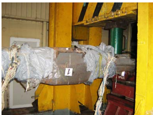
Рис. 5. Навантаження балки надресорної вертикальним навантаженням по черзі до кронштейнів ковзунів ( P_{ск} )
