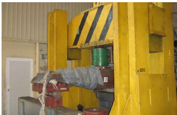
Рис. 3. Навантаження балки надресорної вертикальним навантаженням прикладеної до опорної поверхні під'ятника ( P_n )
