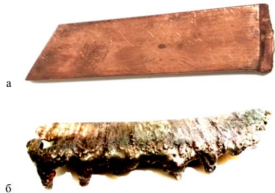
Рис. 3. Мідь пантографна для струмоприймачів (шина мідна): а – нова ; б – після експлуатації
