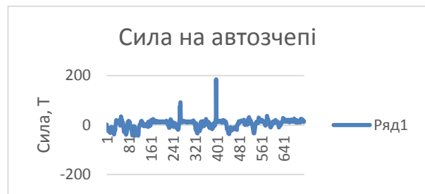
Рис. 9. Сила на автозчепному пристрої
