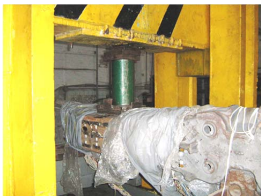
Рис. 6. Навантаження балки надресорної горизонтальним навантаженням, прикладеної до вертикальної стінки балки ( T )
