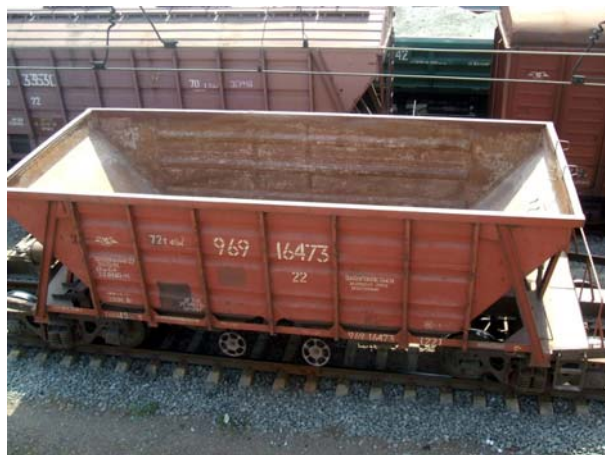
Рис. 2. Вагон-хопер для цементу зі знятою кришею моделі 19-758-01
