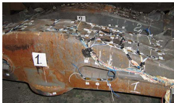
Рис. 2. Встановлення тензорезисторів на надресорній балці
