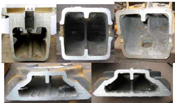
Рис. 10. Балка надресорна порізана по перетинах з метою контролю розмірів елементів конструкції
