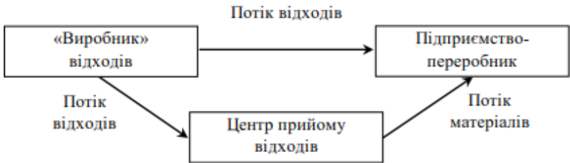
Рис. 6.3. Схема управління потоком відходів, які підлягають переробці
