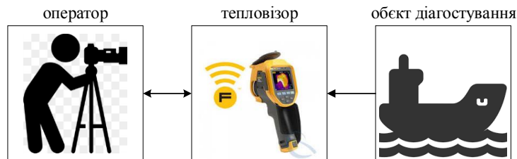
Рис. 2. Структура системи діагностування на основі кількісної термографії
