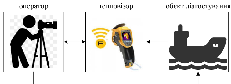
Рис. 3. Структура системи діагностування на основі кількісної термографії (спеціальний режим)
