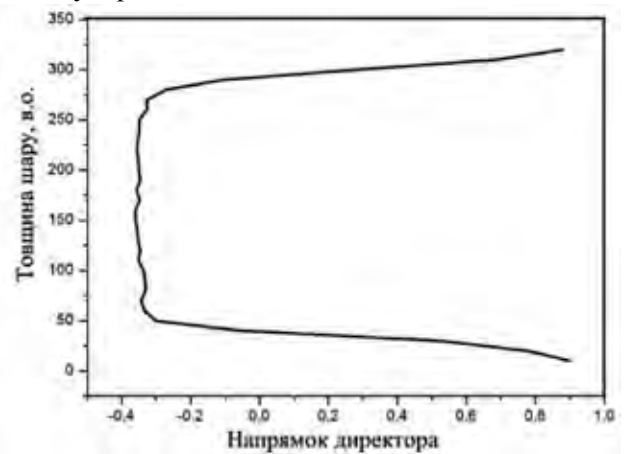
Рис. 1. Розподіл директора в шарі нематичного рідкого кристала, отриманий за результатами комп'ютерного моделювання при T=500 К, стаціонарний стан під час прикладення зовнішнього електричного потенціалу
