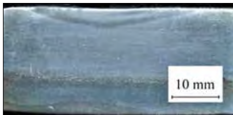
Рис. 4. Зразок, який був підданий нагріву плазовою дугою, що сканує
