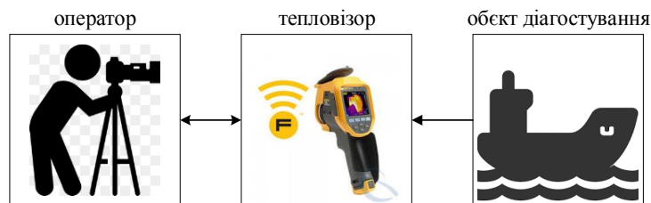
Рис. 2. Структура системи діагностування на основі кількісної термографії
